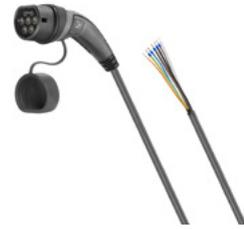
Ladekabel für bis zu 22 kW Ladeleistung bei 3-phasigem Anschluss, Steckertyp Ladepunkt: offen, Steckertyp Fahrzeug: Typ 2, 10 m Kabellänge, Steckerfarbe schwarz/grau, Kabelfarbe schwarz
