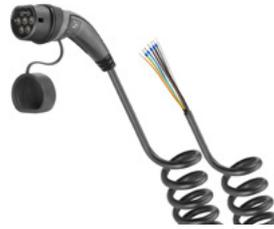
Ladekabel für bis zu 22 kW Ladeleistung bei 3-phasigem Anschluss, Steckertyp Ladepunkt: offen, Steckertyp Fahrzeug: Typ 2, 7,5 m Kabellänge, Steckerfarbe schwarz/grau, Kabelfarbe schwarz
