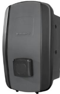
Mode 3 Wallbox AC SMART VALUE, max. Ladeleistung von 22 kW bei 3-phasigem (400 V) Netzanschluss, maximaler Ladestrom 32 A, angeschlagenes 5/7,5 m Kabel mit Typ 2 Stecker, RFID-Authentifizierung, integrierter Webserver mit statischem Lastmanagement, mobile App, Schnittstellen: 2x Ethernet, WLAN, Bluetooth LE, RS 485, 5 DI, 1 DO
