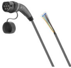
Ladekabel für bis zu 11 kW Ladeleistung bei 3-phasigem Anschluss, Steckertyp Ladepunkt: offen, Steckertyp Fahrzeug: Typ 2, 7,5 m Kabellänge, Steckerfarbe schwarz/grau, Kabelfarbe schwarz
